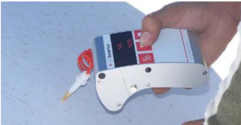
Figura 1. Muestreo del nivel de \text{O}_2 y \text{CO}_2 con un medidor portátil de gases.
